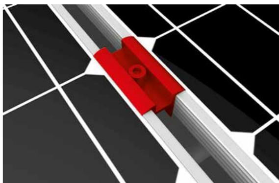
**Fixation avec étriers universels intermédiaires OneMid:** entre deux modules, utiliser deux étriers universels intermédiaires. Cliquer la base de l'étrier dans la cavité du rail. Fixer l'étrier au cadre du module. Respecter les indications de fixation du fabricant du module.
