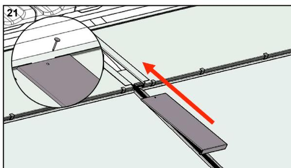
Montez les Tôles recouvrement de dilatation
