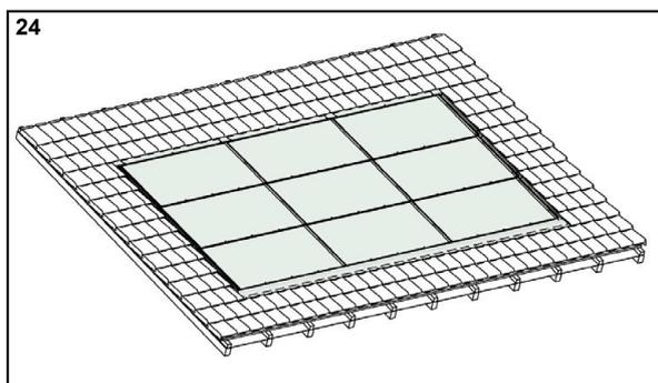
Remplir le toit de tuiles, couper les tuiles sur mesure si nécessaire
