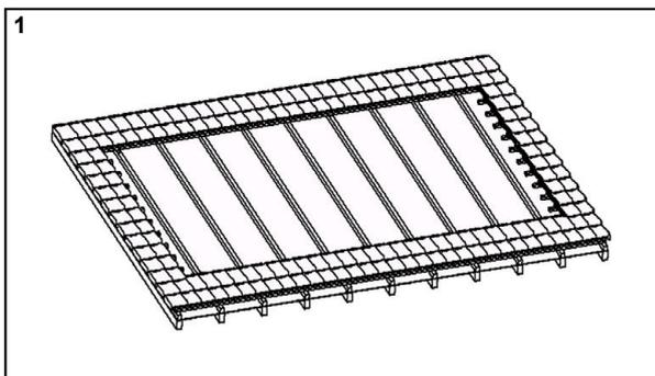
1 Enlevez généreusement les tuiles et si nécessaire également les lattes à tuiles dans la zone de la surface des modules photovoltaïque
