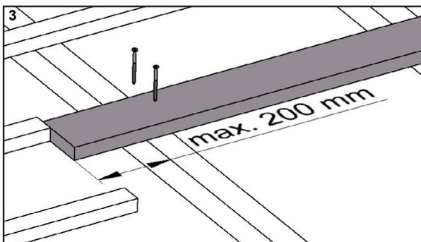
3 Fixez les Planches Solrif® avec des vis à bois appropriées dans la dimension de la trame verticale  $R_{ve}$
